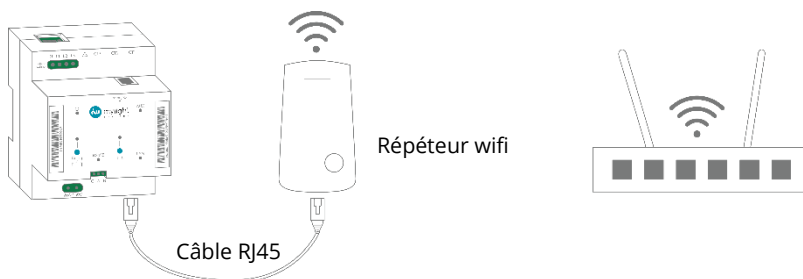
Figure 4 : Schéma de connexion internet via répéteur wifi
